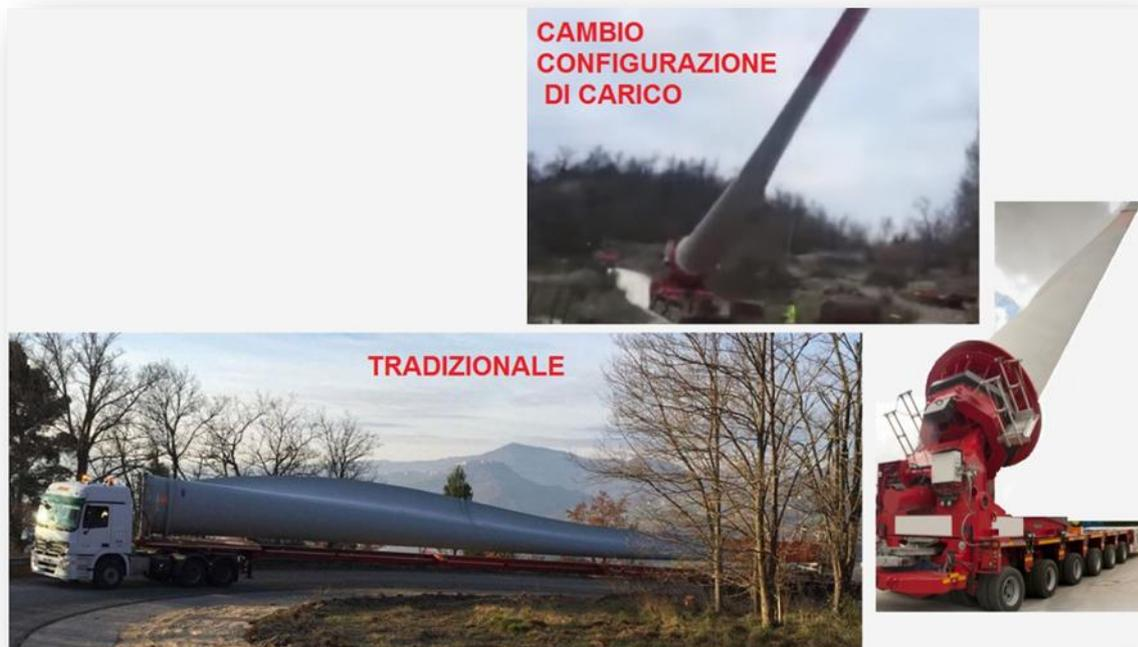
Figura 20 – Esempi di trasporto tradizionale e soluzione con cambio della configurazione di carico durante il percorso
