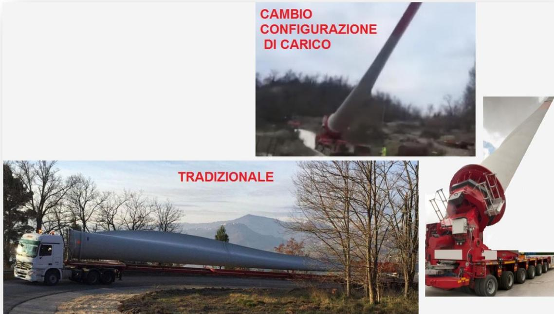
Figura 9 – Esempi di trasporto tradizionale e soluzione con cambio della configurazione di carico durante il percorso
