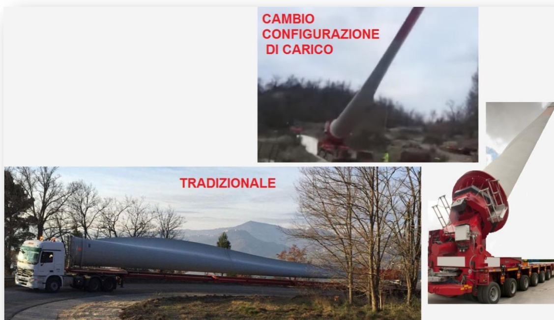
Figura 106 – Esempi di trasporto tradizionale e soluzione con cambio della configurazione di carico durante il percorso
