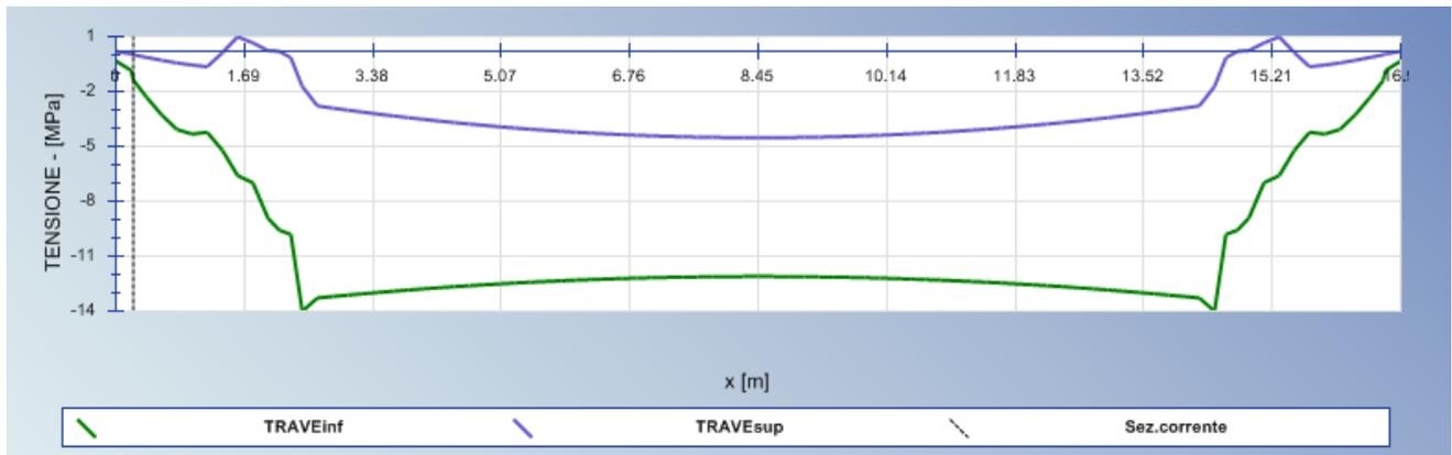
Figura 10.46 : Andamento delle tensioni lungo la trave
