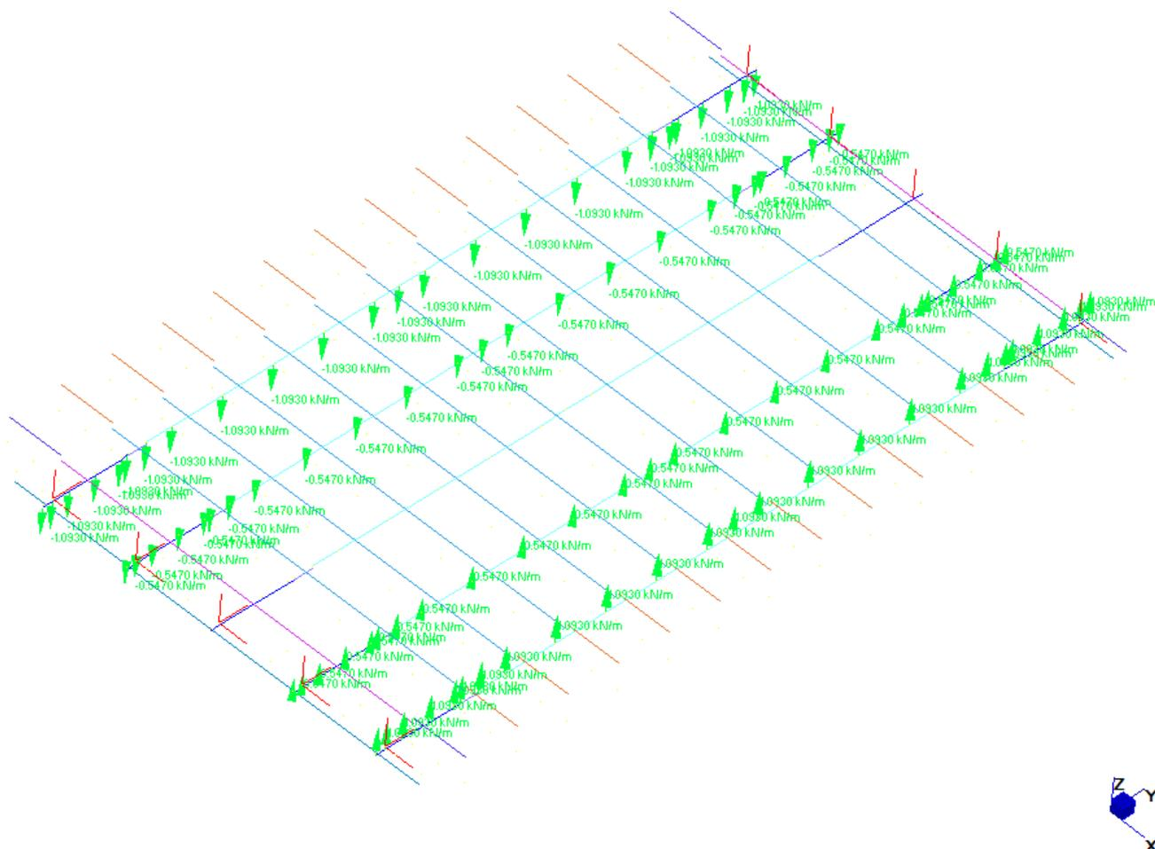
Figura 10.20 : Carichi da vento Q5 applicati nel modello
