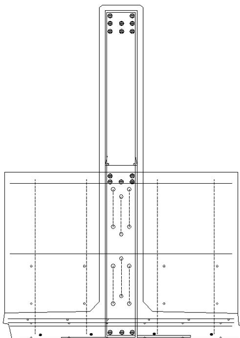
Figura 11.22 : Armatura elemento a T prefabbricato
