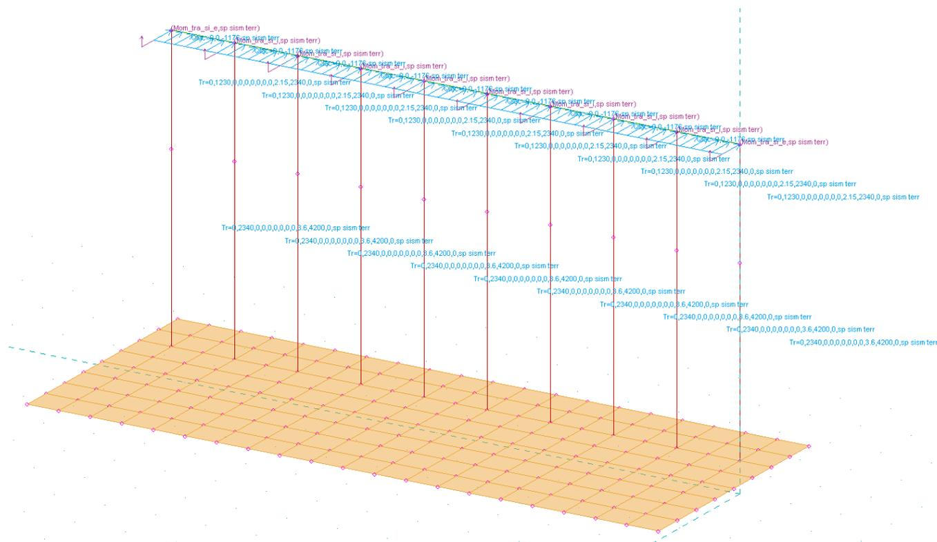
Figura 11.8 : Spalla caricata con le sovraspinta del terreno in condizioni sismiche
