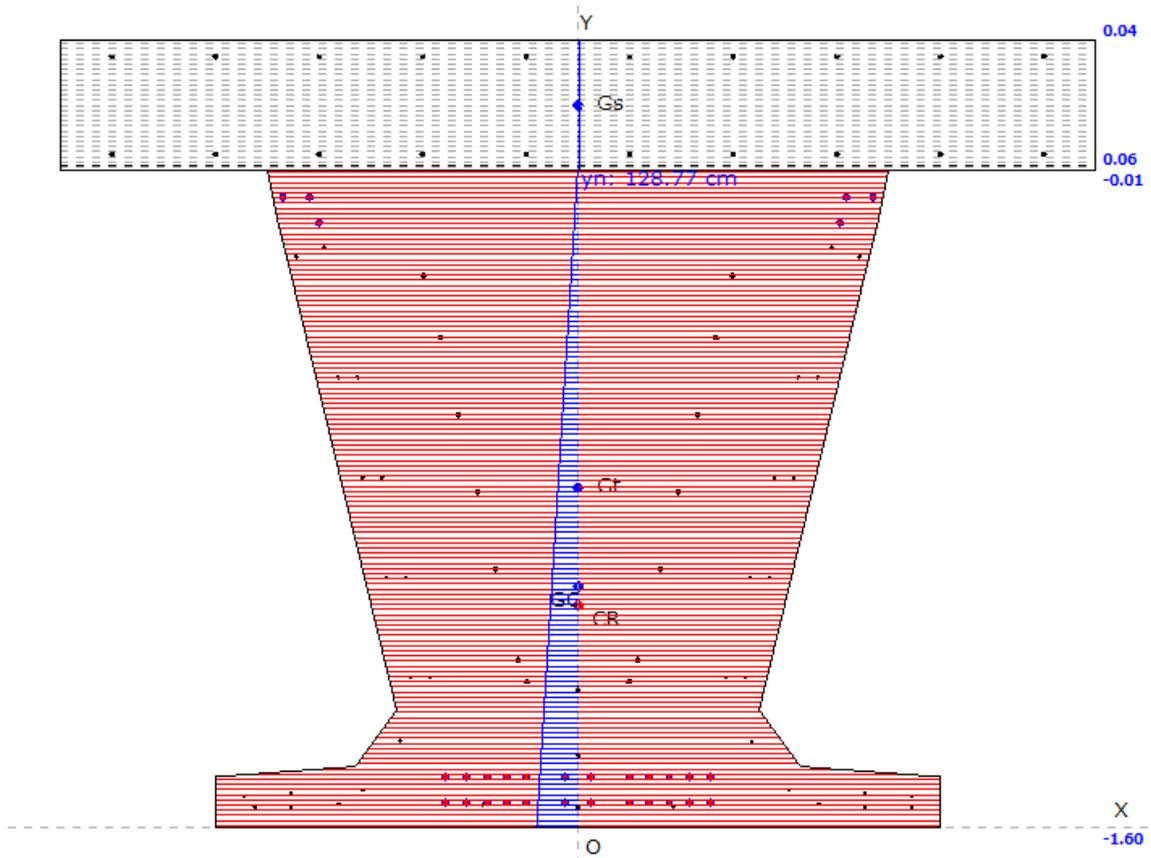
Figura 10.53 : Diagramma delle tensioni sulla sezione in campata
