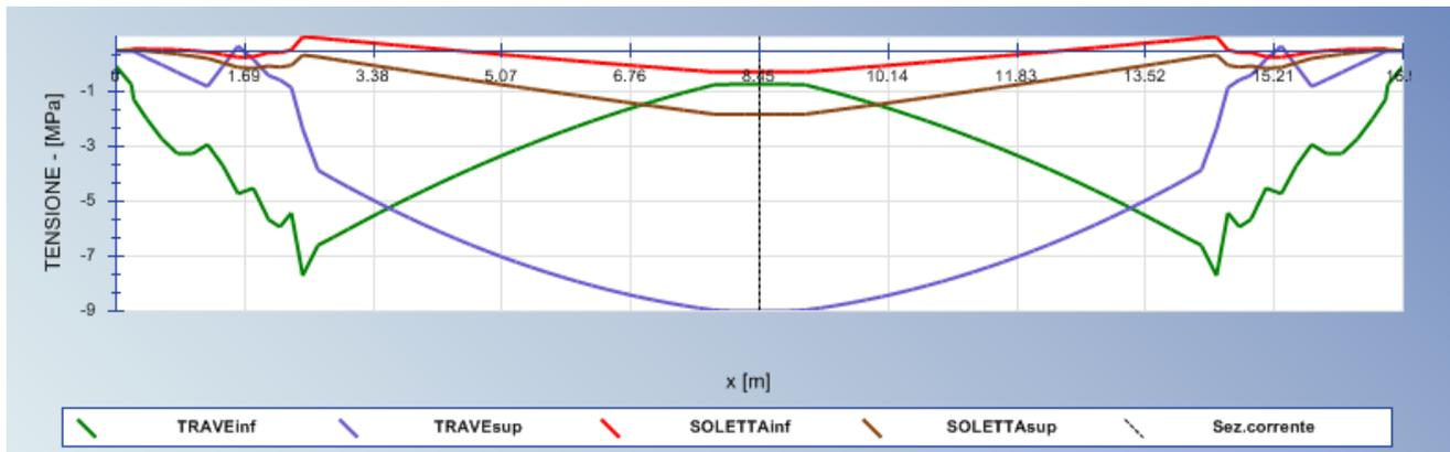
Figura 10.52 : Andamento delle tensioni lungo la trave
