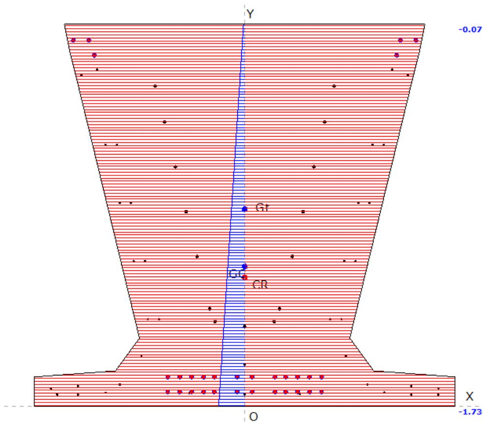
Figura 10.49 : Diagramma delle tensioni sulla sezione all'appoggio
