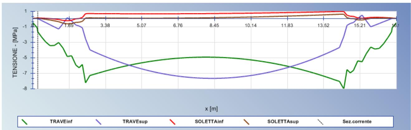
Figura 10.54 : Andamento delle tensioni lungo la trave
