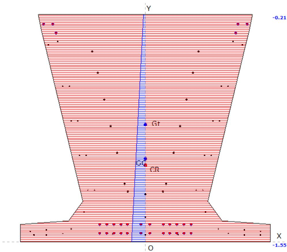
Figura 10.45 : Diagramma delle tensioni sulla sezione all'appoggio
