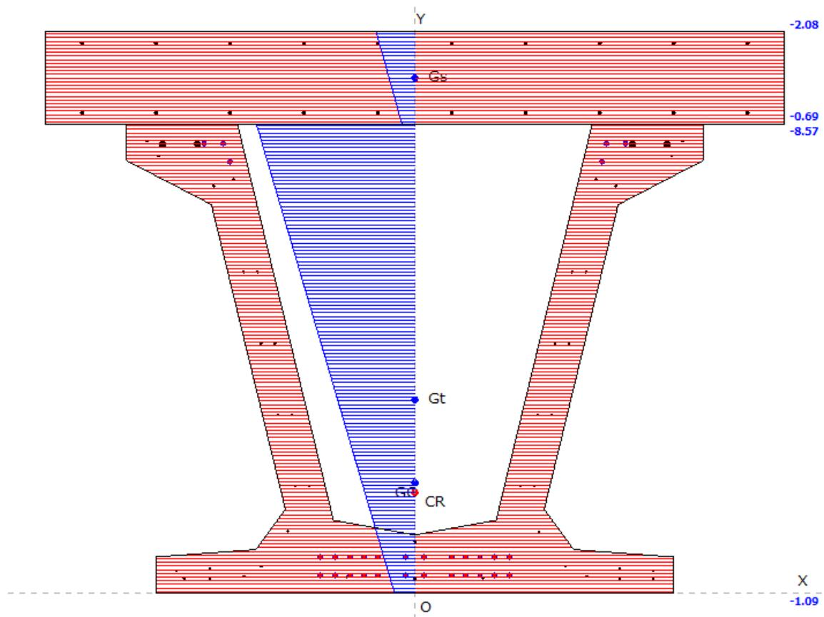
Figura 10.51 : Diagramma delle tensioni sulla sezione in campata
