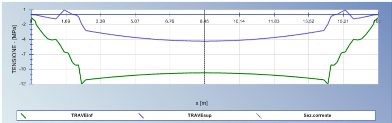
Figura 10.48 : Andamento delle tensioni lungo la trave
