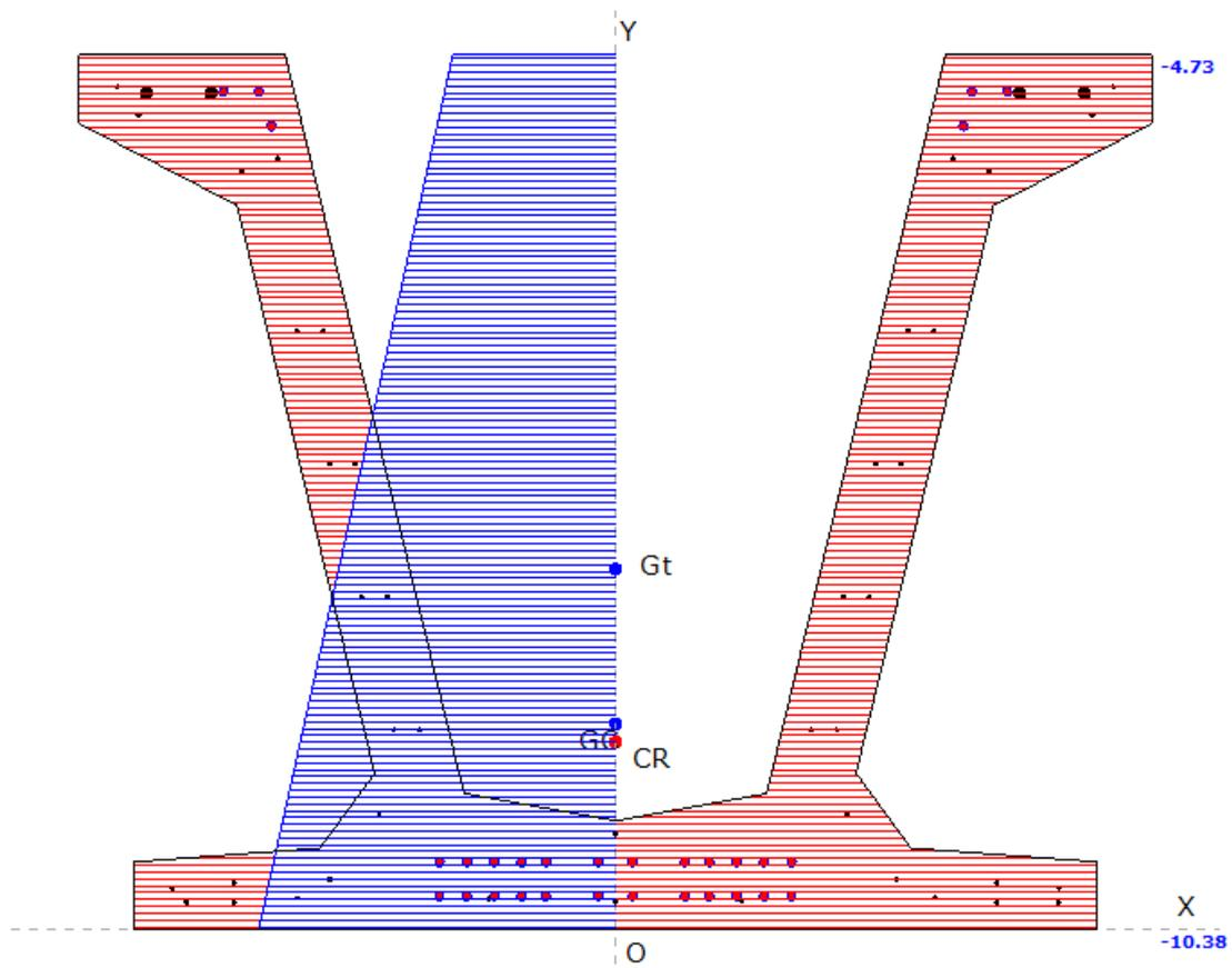
Figura 10.47 : Diagramma delle tensioni sulla sezione in campata
