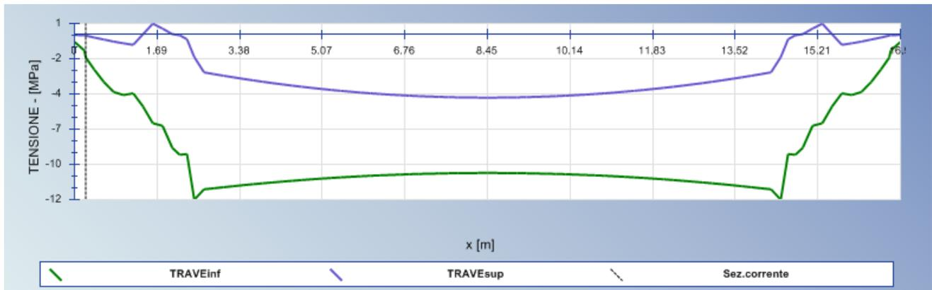
Figura 10.50 : Andamento delle tensioni lungo la trave
