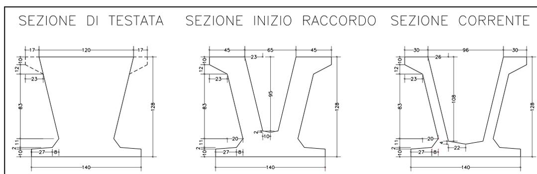
Figura 10.2 : Sezioni trasversali della trave prefabbricata
