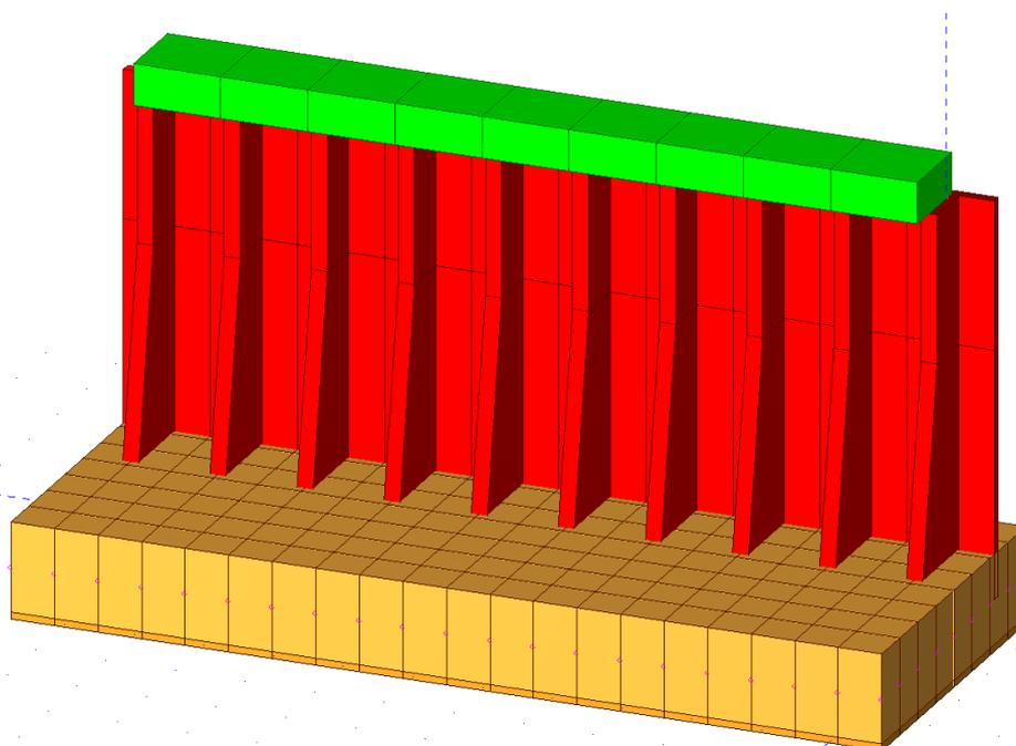
Figura 11.1 : Modello di calcolo della spalla
