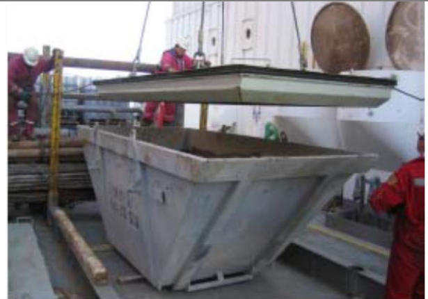
Coperchio metallico e cassonetto multibenna con particolare della guarnizione di tenuta
