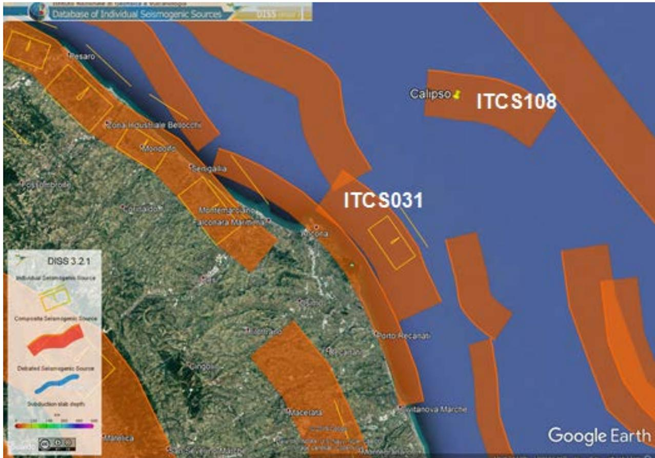
Fig. 15: mappa delle faglie sismogenetiche estratta dal DISS 3.2.1. I rettangoli gialli sono le proiezioni in superficie delle sorgenti sismogenetiche individuali. Le fasce arancioni sono invece le proiezioni delle sorgenti sismogenetiche composite, di cui evidenziate la ITCS108 (Clara) e la ITCS031 (Conero offshore)
