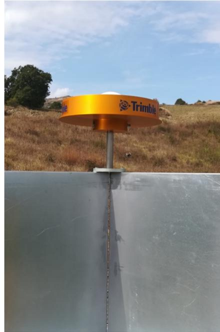
*Corner reflector e dettaglio dell'antenna CGPS*
