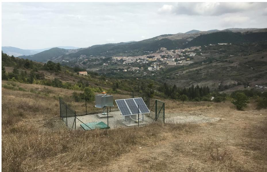
*Stazione di monitoraggio integrata TR07 (sismica, GNSS, Corner reflector InSAR)*
