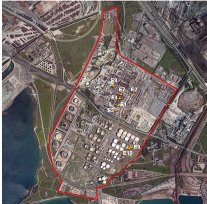
Figura 4.1 Localizzazione delle Sorgenti Emissive della Raffineria
