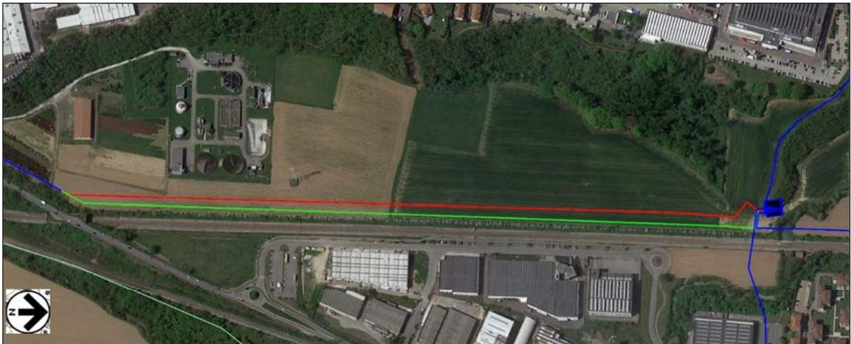
Figura 1.1/C – Inquadramento territoriale su immagine aerea (in rosso variante in progetto, in verde tracciato in dismissione, in blu esistenti)
