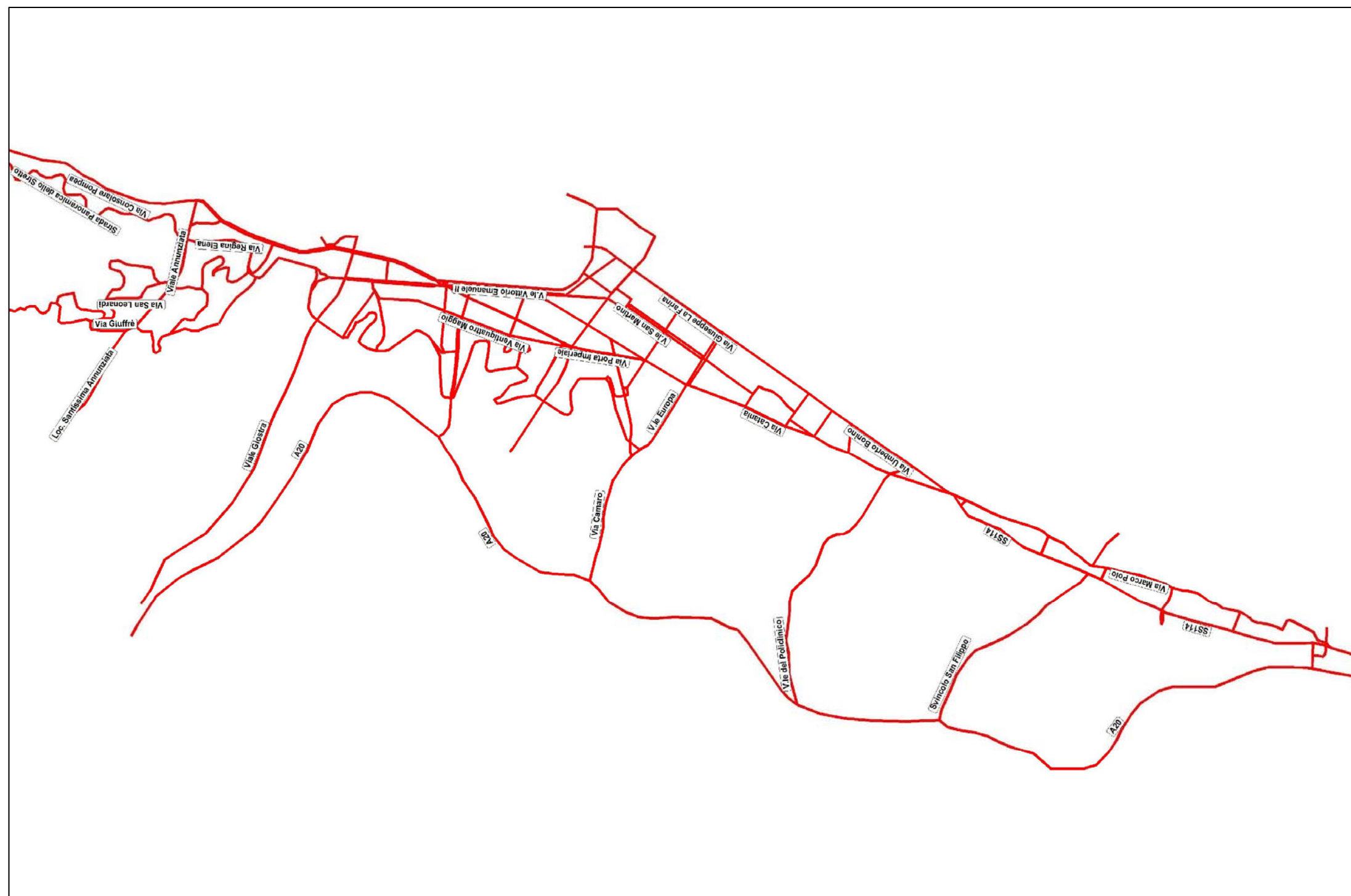
Tavola 3: Flussi di traffico nell'ora di punta del mattino durante la fase di cantiere, in veicoli equivalenti, al netto dei transiti aggiuntivi di mezzi pesanti.
