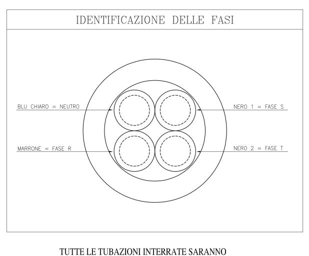
DA REALIZZARE MEDIANTE TUBO IN POLIETILENE A DOPPIA PARETE CON I DIAMETRI INDICATI NELLE PLANIMETRIE L.01-02-03-04 LE ALTRE PROTEZIONI MECCANICHE DOVRANNO ESSERE REALIZZATE CON MATERIALI INDICATI NELLA SEZIONE TIPO DEL PRESENTE ELABORATO GRAFICO
