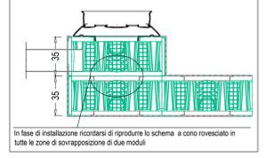
Trincea drenante tipo Rigo-Fill ST con Quadro-control - Pianta: trincea 4 strati
