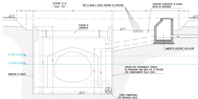
INTERFERENZA N°22 - SCAVO VIA TIEPOLO - Scala 1:50
