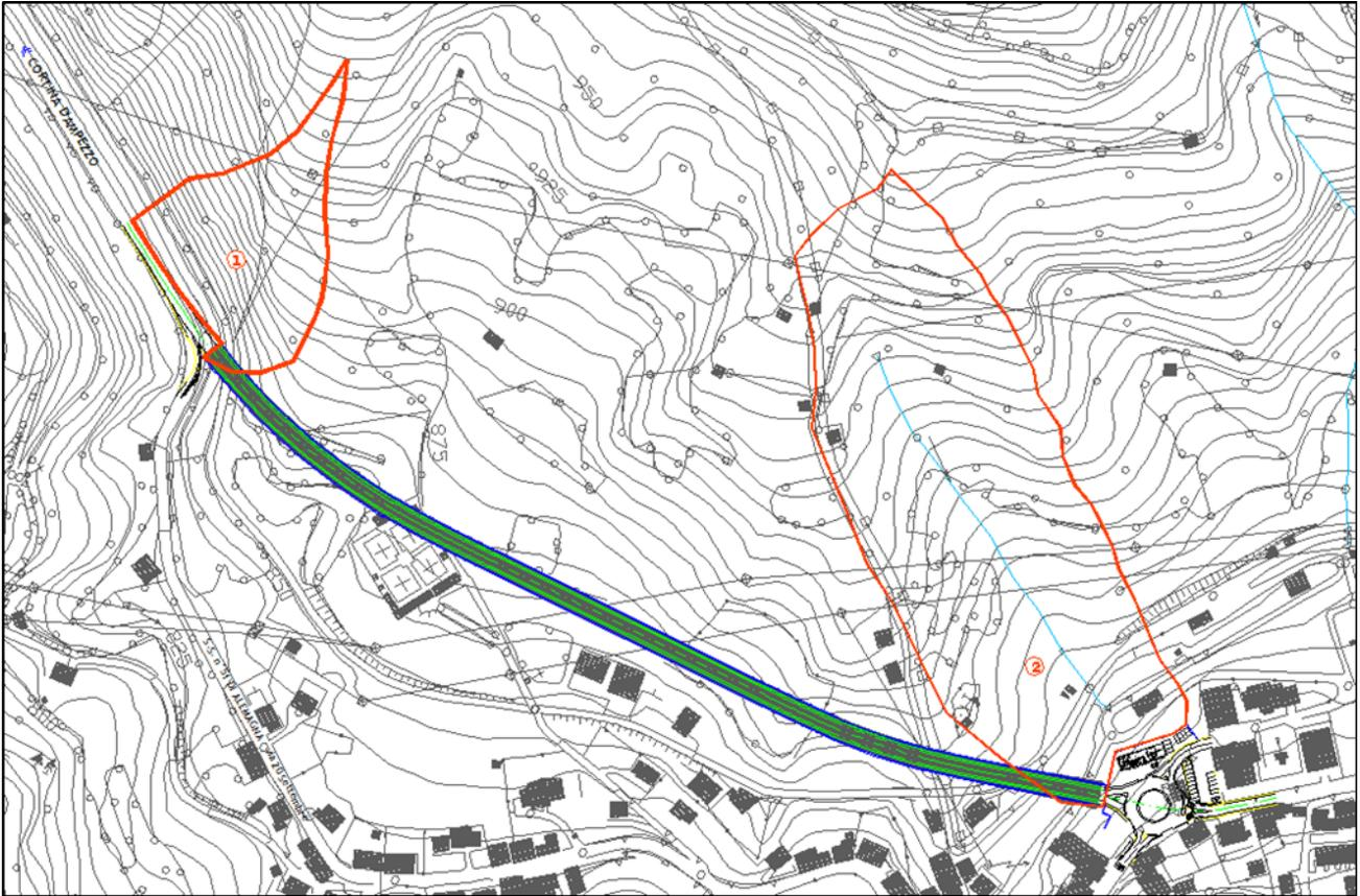
I bacini in esame presentano estensioni limitate, solamente quello sull'imbocco est è dotato di un'asta torrentizia definita, ma il progetto non prevede opere di attraversamento per le portate dei bacini individuati, poiché:
