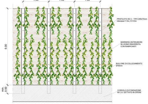
SEZIONE TIPO IN RILEVATO CON BARRIERA ANTIRUMORE
