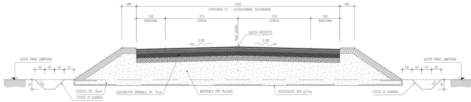
SEZIONE TIPO RAMI DI ACCESSO ROTATORIE SCALA 1:50
