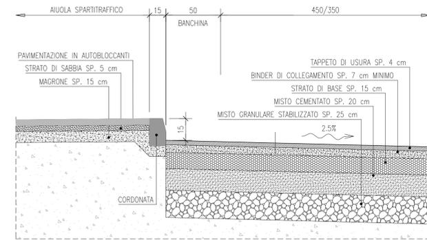
SEZIONE TIPO ROTATORIA RAGGIO 25,00m SCALA 1:50
