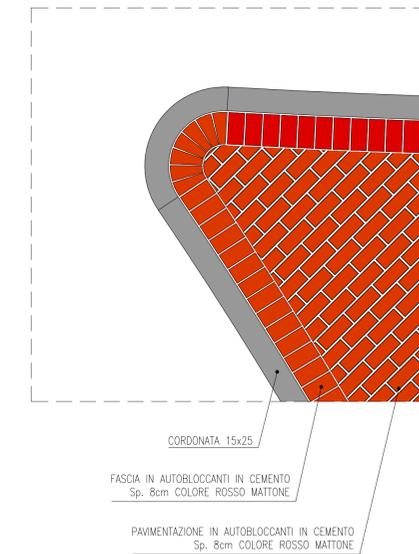
PARTICOLARE PAVIMENTAZIONE STRADALE SCALA 1:20
