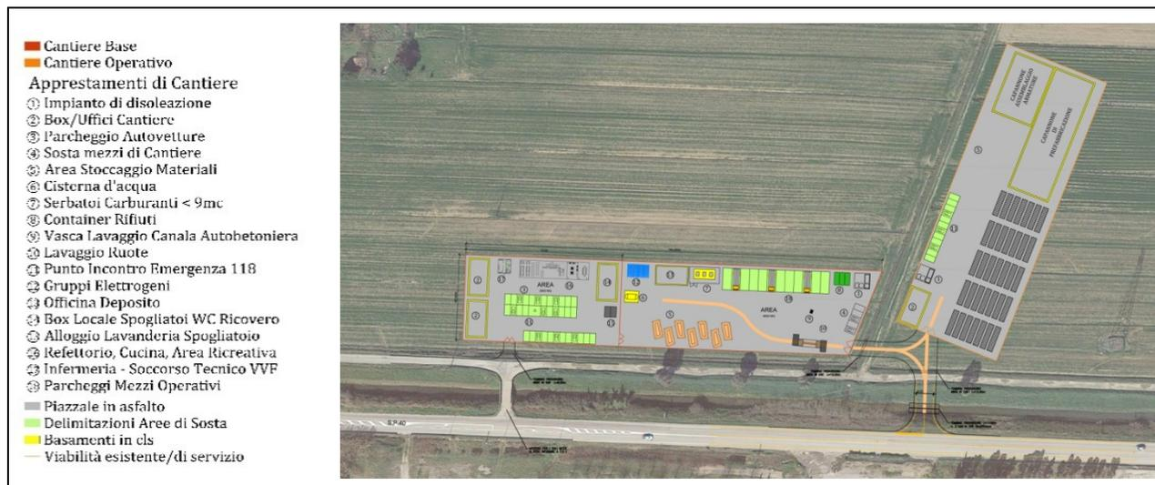
Figura 4-30: Localizzazione area del Cantiere Base (Elab.: T00-CA00-CAN-PL03-A)
