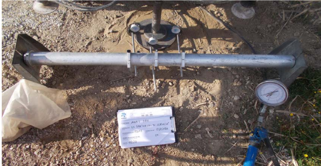
Prova di carico su piastra PZA 8
