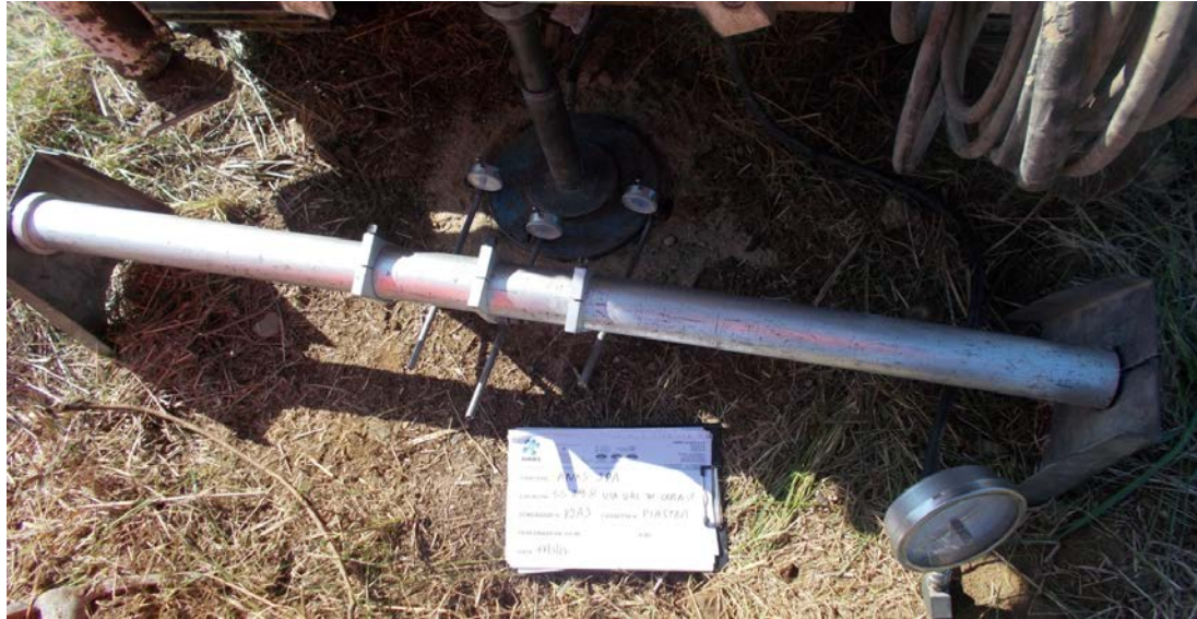
Prova di carico su piastra PZA 3
