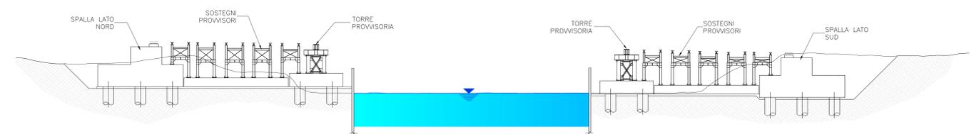
NOTA: PER AGEVOLARE LE OPERAZIONI DI TESATURA DEI CAVI, LE TRAVI PARAGHIAIA SARANNO REALIZZATE SUCCESSIVAMENTE
