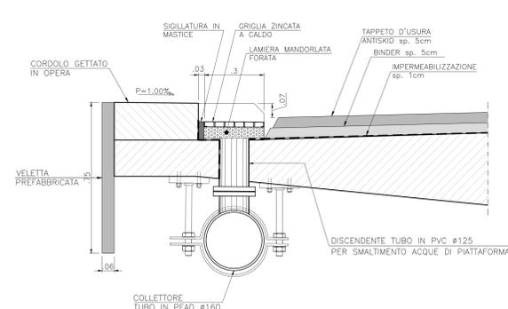
**DETTAGLIO COLLARE DI FISSAGGIO**
