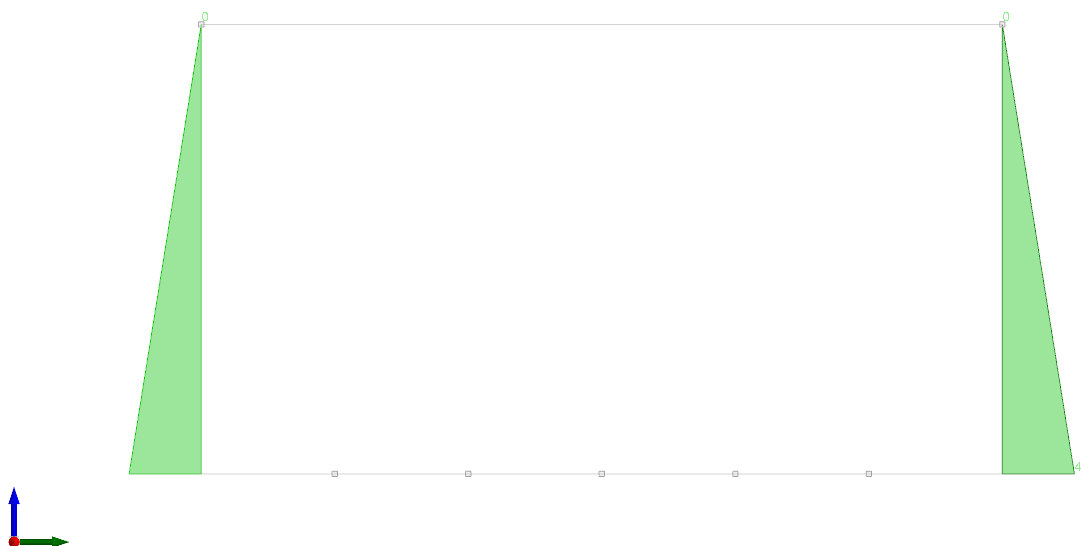
Figura 6 - Condizione spinta terreno A1-M1
