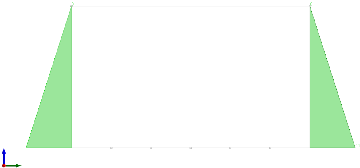
Figura 6 - Condizione spinta terreno A1-M1
