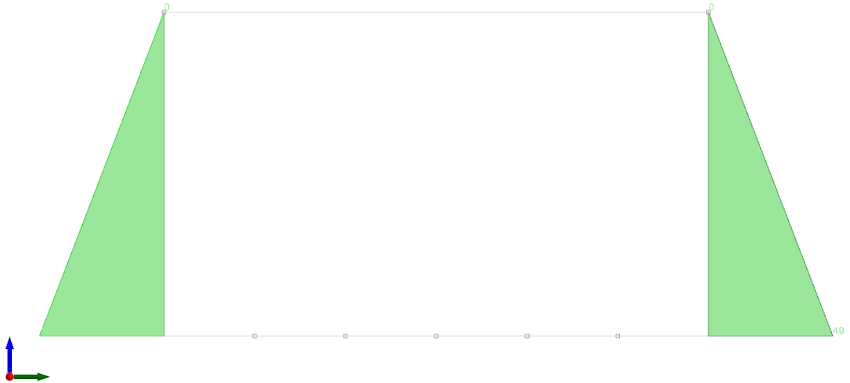
Figura 7 - Condizione spinta terreno A2-M2
