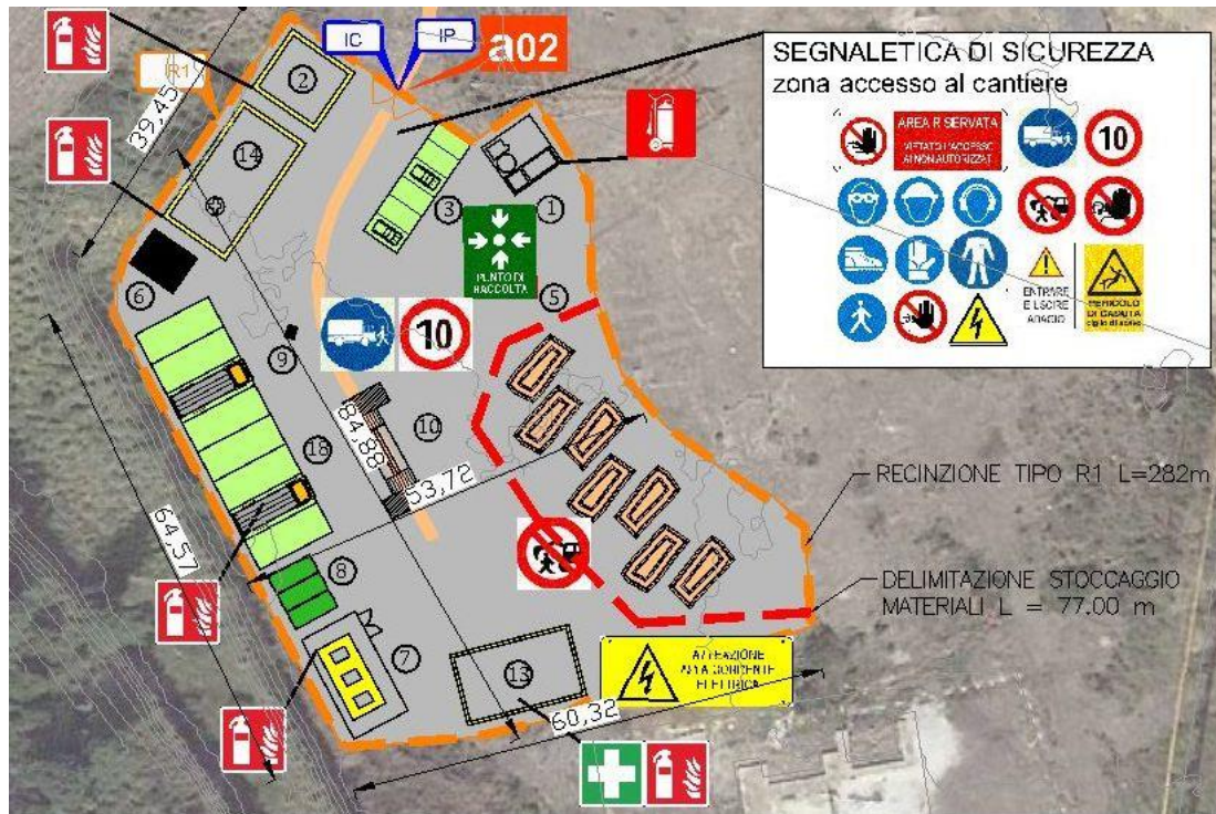
Localizzazione area di cantiere CO2
