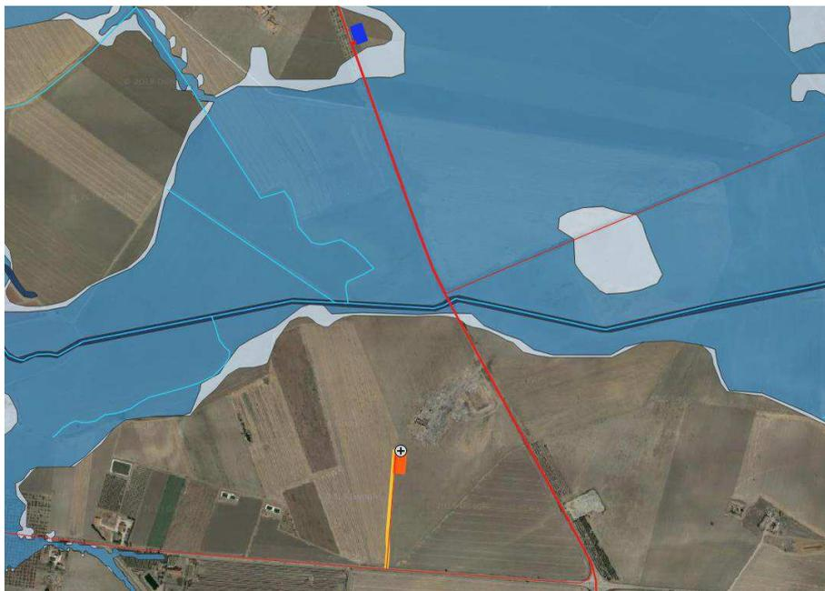
5. **INTERSEZIONI 6 e 7** – Tratto di cavidotto da realizzarsi su strada esistente. Interferenza con aree a bassa, media ed alta pericolosità idraulica e con reticolo idrografico generata (canale Peluso e suo affluente) dal cavidotto di collegamento degli aerogeneratori n.22 e 23 alla cabina di trasformazione. Si prevede la realizzazione del tratto in attraversamento mediante TOC.
