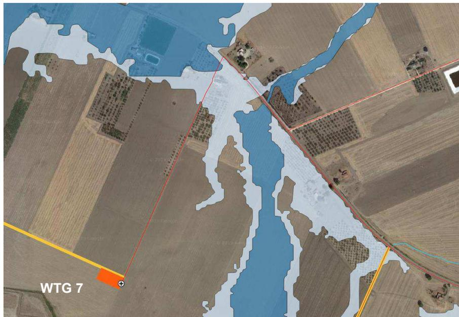
3. Tratto di cavidotto da realizzarsi in sede propria. Interferenza con aree a media pericolosità idraulica generata dal cavidotto di collegamento alla sottostazione. Si prevede la realizzazione del tratto mediante TOC.
