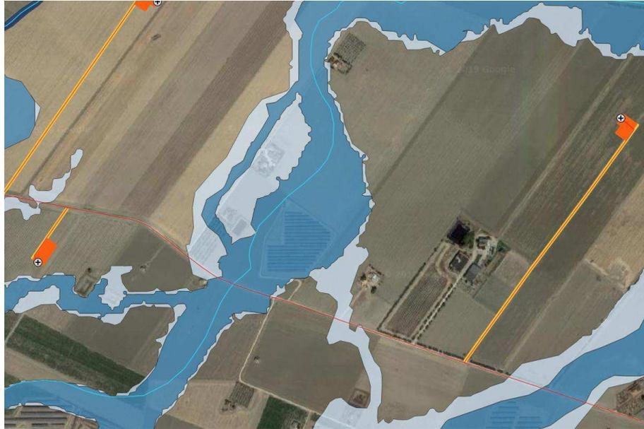
2. **INTERSEZIONI 2 e 3** – Tratto di cavidotto da realizzarsi in parte su strada esistente. Interferenza con aree ad alta e media pericolosità idraulica e con il reticolo idrografico (canale Macchia Rotonda e suo affluente) generata dal cavidotto di collegamento alla sottostazione esistente. Si prevede la realizzazione dei tratti in attraversamento dei compluvi mediante TOC.
