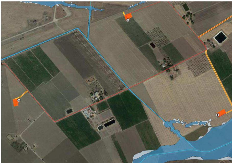
7. **INTERSEZIONE 9** – Tratto di cavidotto da realizzarsi su strada esistente. Interferenza con aree a bassa, media ed alta pericolosità idraulica e con reticolo idrografico (canale Carapelluzzo) generata dal cavidotto di collegamento degli aerogeneratori n.21 e 18. Si prevede la realizzazione del tratto in attraversamento mediante TOC.
