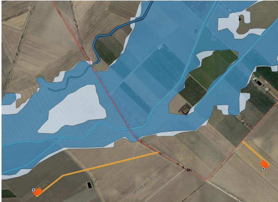
6. **INTERSEZIONE 8** – Tratto di cavidotto da realizzarsi su strada esistente. Interferenza con aree a media pericolosità idraulica e con reticolo idrografico (affluente del Canale Peluso) generata dal cavidotto di collegamento degli aerogeneratori n.15 e 16. Si prevede la realizzazione del tratto in attraversamento mediante TOC.
