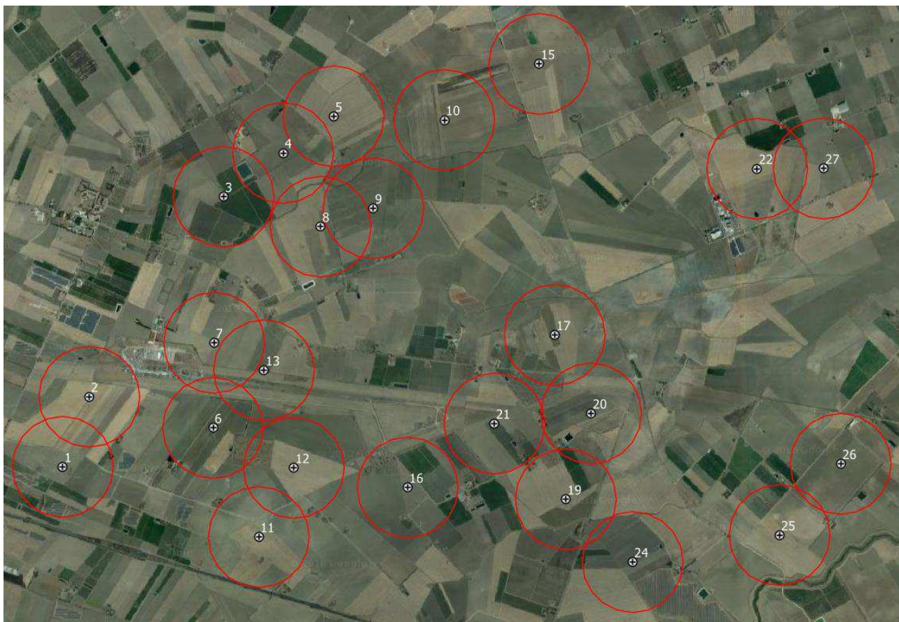
Individuazione Buffer da asse aerogeneratori pari 474 m (3 volte il diametro del rotore)
