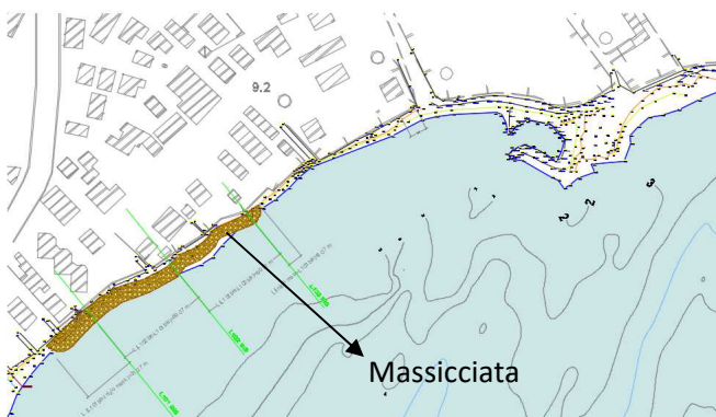
Figura 2.2.a: Planimetria di progetto delle opere del progetto esecutivo di 1° stralcio delle Opere di difesa a salvaguardia della linea di costa nel comune di Avola (opere già realizzate).
