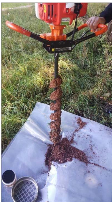
Figura 18 – Aliquota di terreno prelevata con la trivella
