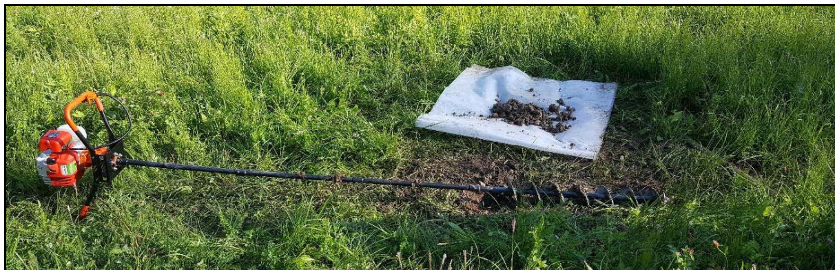
Figura 17 – Trivella motorizzata dotata di prolunghe
