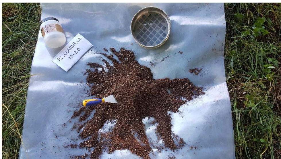
Figura 19 – Esempio setacciatura e omogeneizzazione del campione
