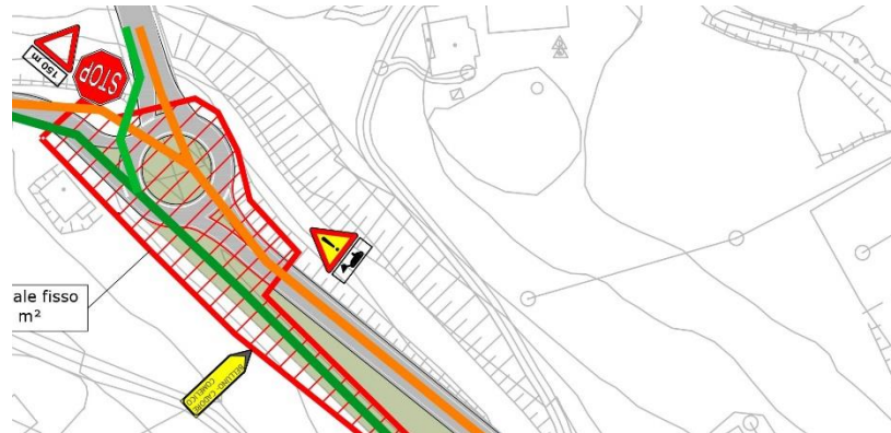
Figura 5 - Direzione dei flussi di traffico ed area di cantiere stradale fisso numero 1
