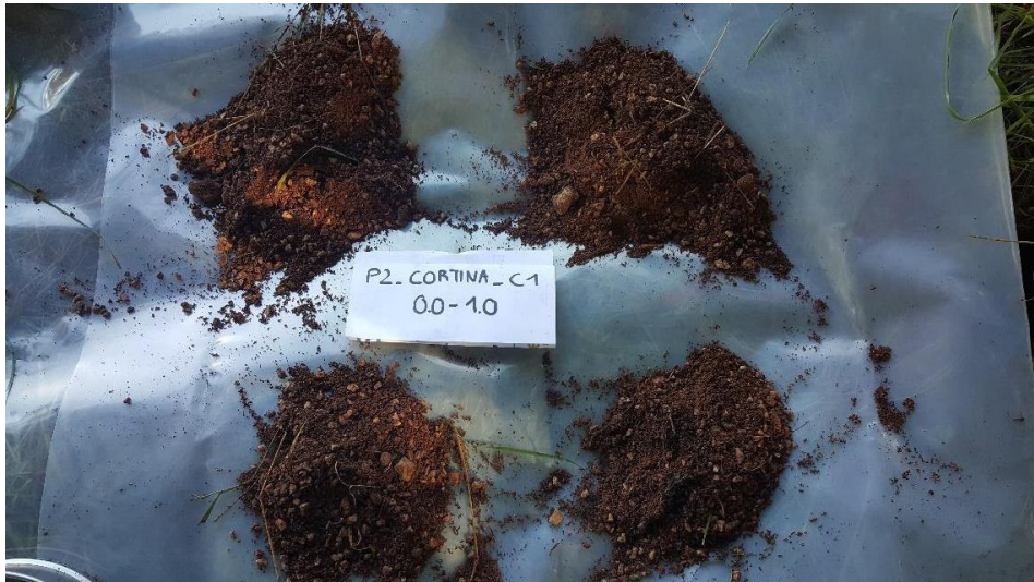
Figura 45 – Esempio quartatura del campione
