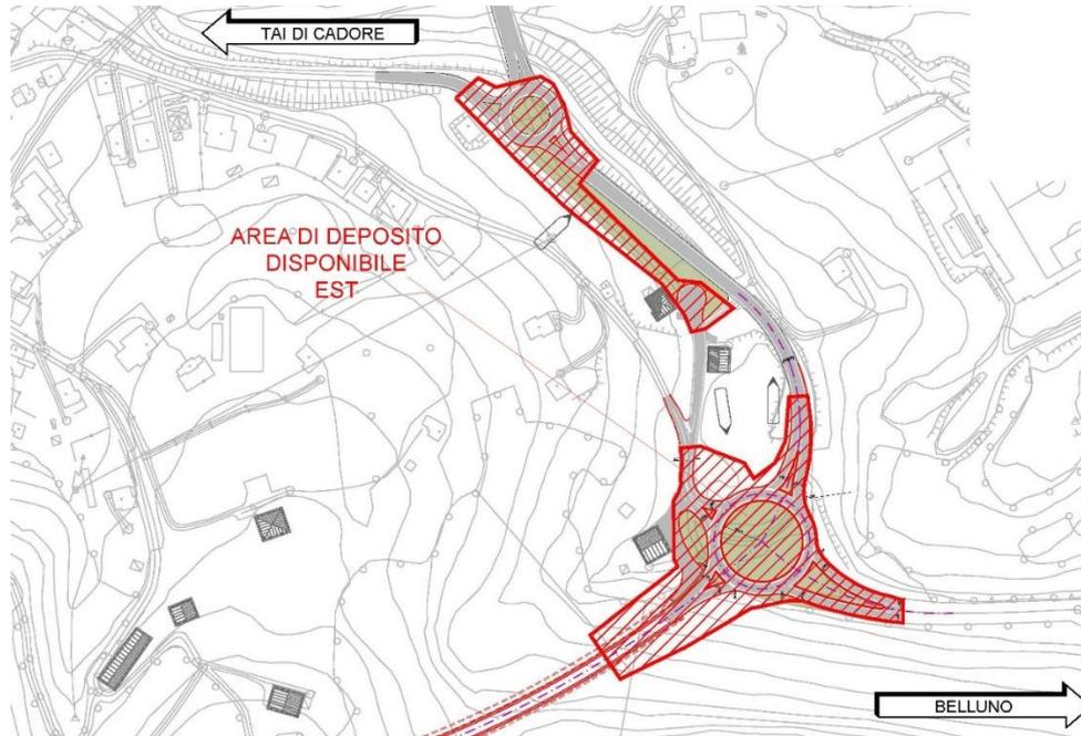
Figura 39 Direzione dei flussi di traffico ed area di cantiere stradale fisso numero 1
