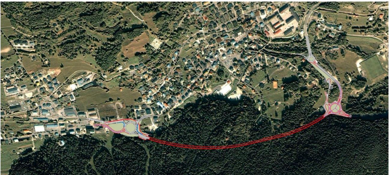
Figura 10 Progetto di variante con modifica del tracciato della galleria, abbandono della galleria di fuga in posizione centrale al passaggio in sotterraneo, modifiche dello svincolo Est, lievi modifiche allo svincolo Ovest"
