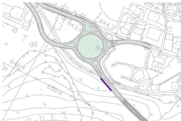
Figura 21 Localizzazione muro di controripa zona svincolo Ovest
