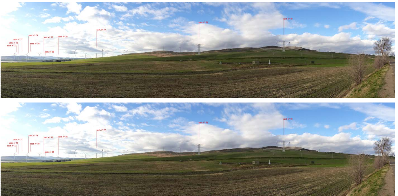
Figura 5.9. Punto di Vista P4 – Confronto tra il tracciato di progetto autorizzato presso il parco eolico in Comune di Deliceto con sostegni di tipo reticolare (sopra) e con i sostegni di tipo monostelo (sotto)
