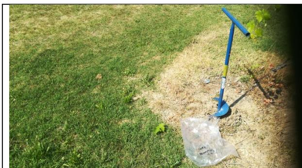
Sondaggio 1 – Effettuato in corrispondenza della futura rotatoria nord, presenza di terreni limo-sabbiosi.
