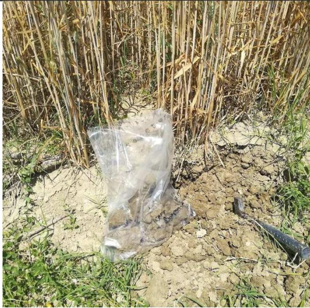
Sondaggio 13 – Effettuato nel campo agricolo a sud della A/14, in corrispondenza della futura rampa a doppia corsia, presenza di terreni limo-sabbiosi.
