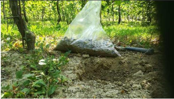
**Sondaggio 3 – Effettuato in corrispondenza della futura rotatoria nord, presenza di terreni limo-sabbiosi.**
