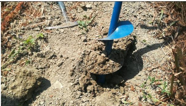
**Sondaggio 5 – Effettuato alla base della scarpata settentrionale della A/14, in corrispondenza della futura rampa di entrata a corsia singola, presenza di terreni limo-sabbiosi.**
