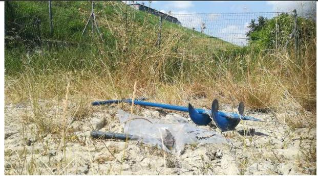
**Sondaggio 4 – Effettuato alla base della scarpata settentrionale della A/14, in corrispondenza della futura rampa di uscita a corsia singola, presenza di terreni limo-sabbiosi.**
