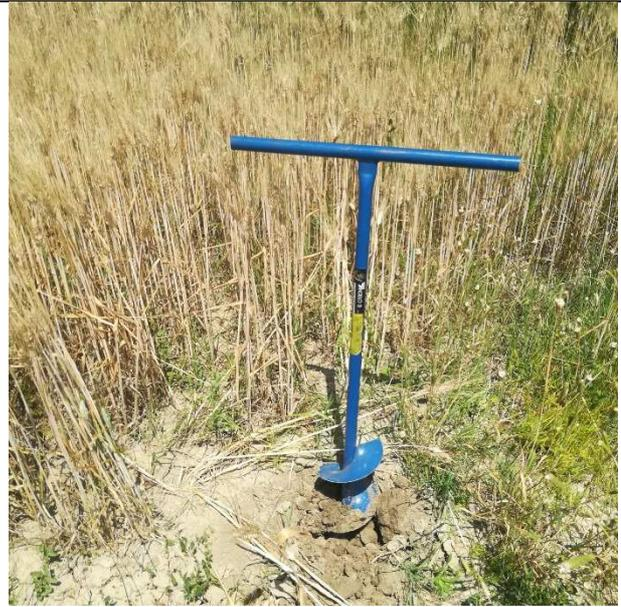
Sondaggio 14 – Effettuato nel campo agricolo a sud della A/14, in corrispondenza della futura rampa a doppia corsia, presenza di terreni limo-sabbiosi.
