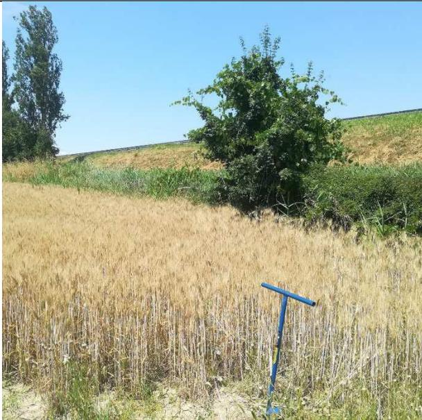
**Sondaggio 11** – Effettuato alla base della scarpata meridionale della A/14, in corrispondenza della futura rampa di entrata a corsia singola, presenza di terreni limo-sabbiosi.
