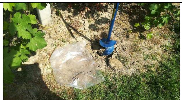
Sondaggio 2 – Effettuato in corrispondenza della futura rotatoria nord, presenza di terreni limo-sabbiosi.
