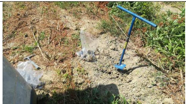
**Sondaggio 6 – Effettuato nel campo agricolo a nord della A/14, in corrispondenza della futura rampa a doppia corsia, presenza di terreni limo-sabbiosi.**
