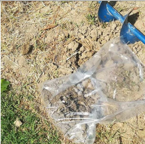
**Sondaggio 7 – Effettuato nel campo agricolo a nord della A/14, in corrispondenza della futura rampa a doppia corsia, presenza di terreni limo-sabbiosi.**
