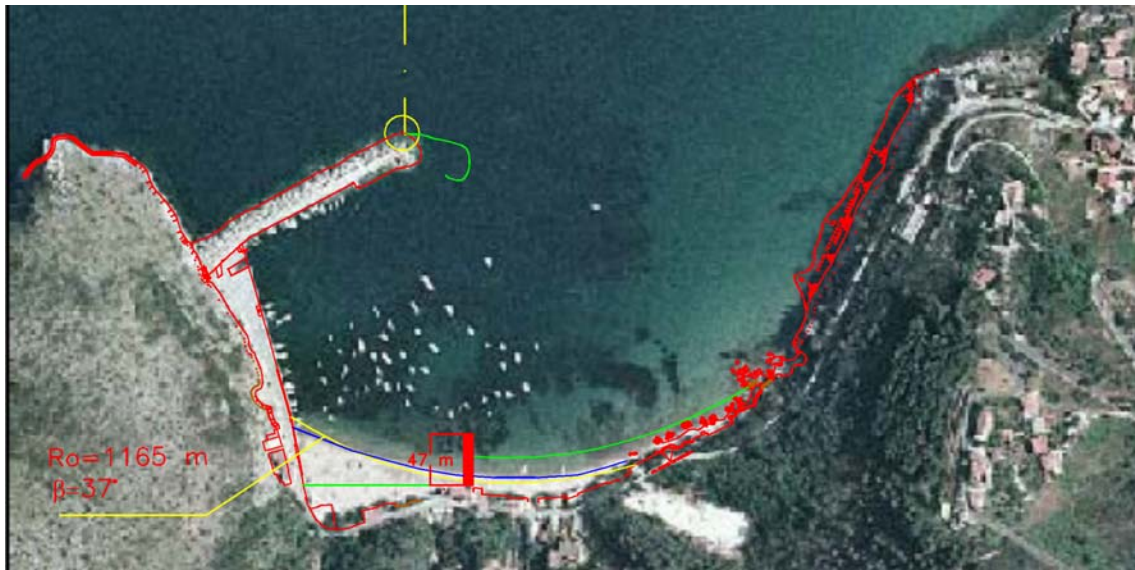
Fig. 5.3.4 – Tracciamento della curva di equilibrio nello scenario A associato alla costruzione di un pennello di sottoflutto
