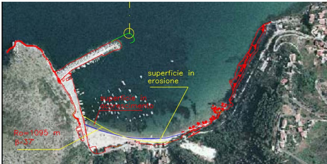
Fig. 5.3.2 – Tracciamento della prima curva parametrica per la previsione della evoluzione futura del litorale nell'ipotesi di assenza di apporto di materiale solido da Nord (scenario B)
