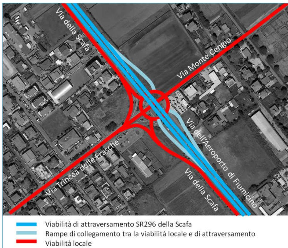
Figura 7.9: Schema progettuale dello Svincolo a Livelli sfalsati per l'Intersezione tra Via dell'Aeroporto di Fiumicino e Via Trincea delle Frasche
