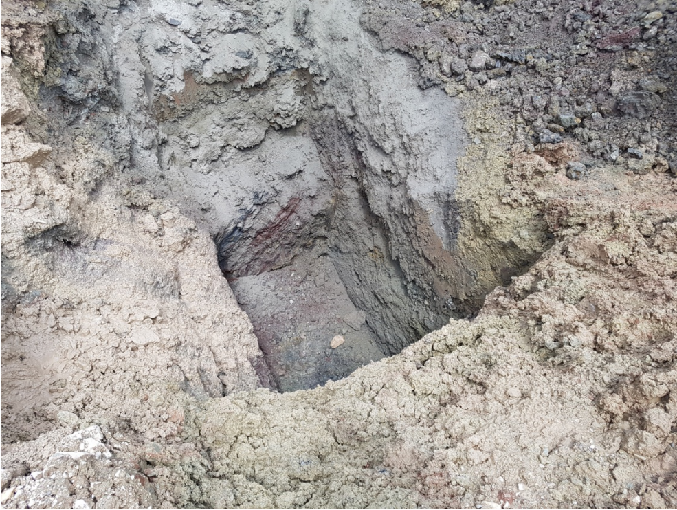
Pozzetto esplorativo P1 ed argille in posto
