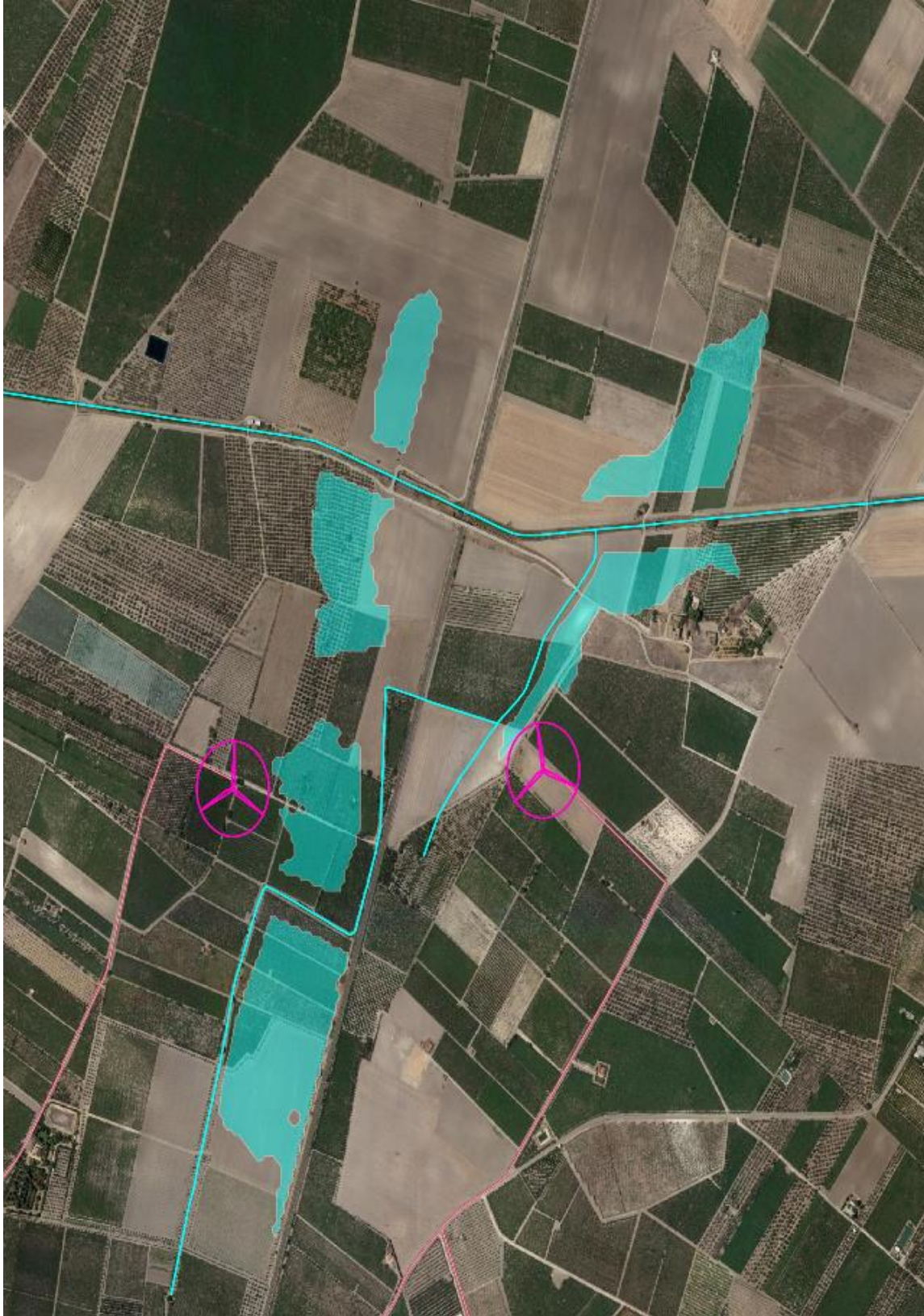
Figura 7. Planimetria Torrente Marana Castello – secondo e terzo segmento e Affluente minore Torrente Marana Castello con individuazione delle sezioni e delle aree potenzialmente interessate dalla portata avente tr = 200 anni e con il risultato della modellazione bidimensionale (tratteggio verde)
