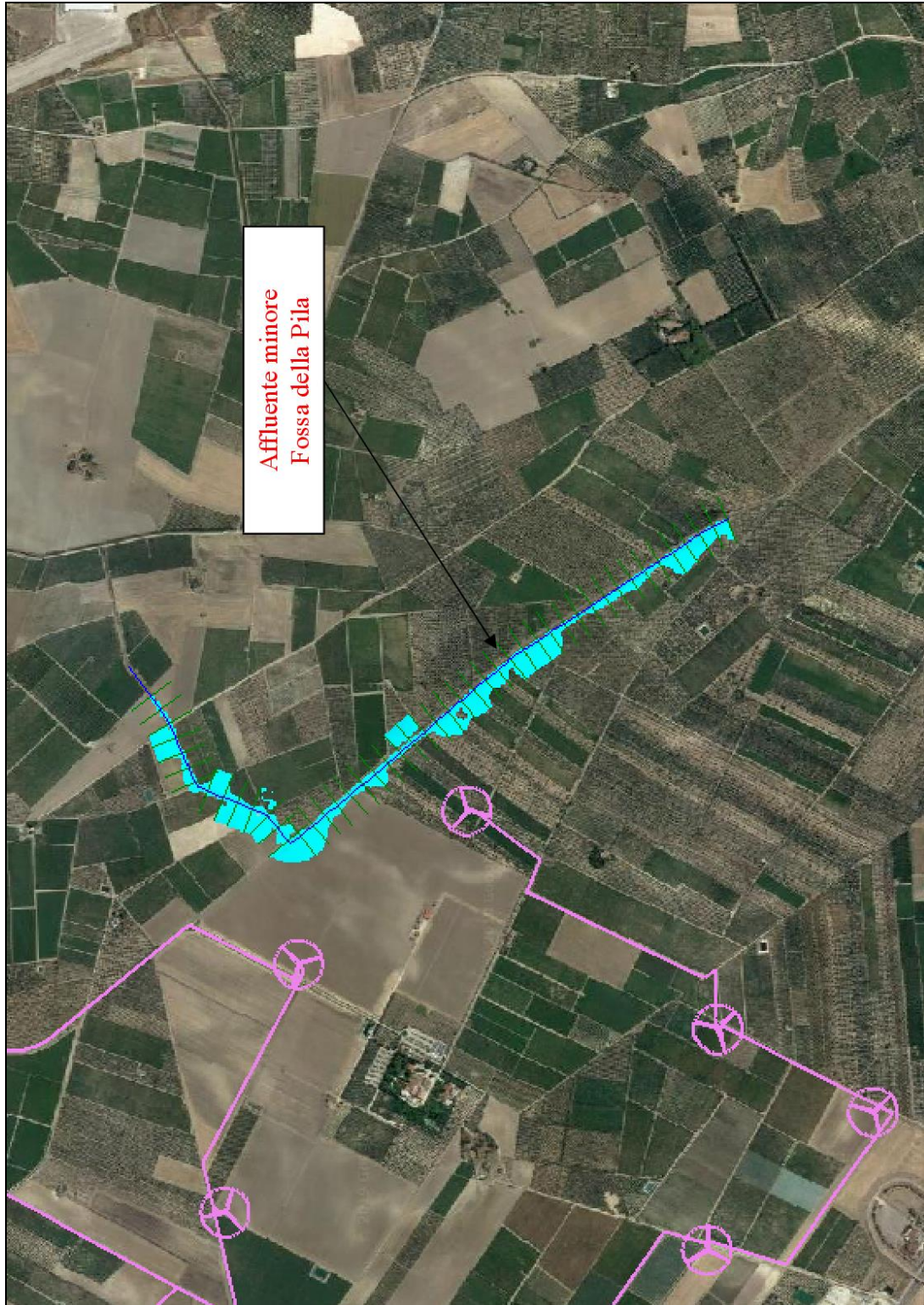
Figura 4. Planimetria con individuazione delle sezioni e delle aree potenzialmente interessate dalla portata avente tr = 200 anni
