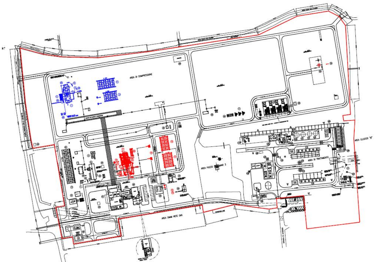
Figura 2.2: Inquadramento delle opere: in rosso le nuove installazioni, in blu gli smantellamenti.
