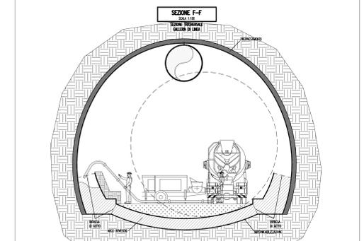
Le fasi 3-4 e 5 si ripetono di sequenza per tutta la lunghezza delle gallerie in allargo
