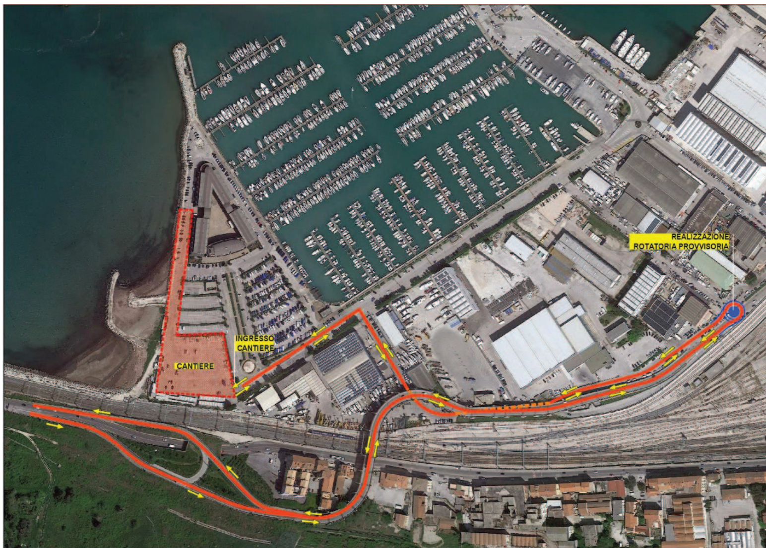
Figura 15 – Percorso viabilità di cantiere
