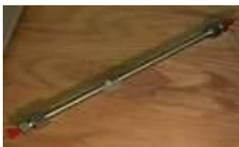
CARATTERISTICHE FISICHE: **5 µm diametro granuli, lunghezza x I.D. 25 cm x 4.6 mm**
