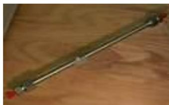
CARATTERISTICHE FISICHE: **5 µm diametro granuli, lunghezza x I.D. 25 cm x 4.6 mm**
