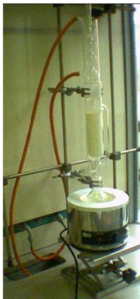
**Materiale:** Apparato elevatore, isomantello, pallone da 250 ml, un apparato di Soxhlet con refrigerante apposito, un ditale di carta, pinze e morsetti, due tubi di gomma, moderatore di ebollizione (sfere di pyrex), cilindro graduato da 250 ml, solvente organico d'estrazione, cilindretto graduato da 10 ml, pipette Pasteur, cristallizzatore, piastra riscaldante, ancorretta magnetica, imbuto, tettarelle, cotone, provetta o protettone da 250 ml.
