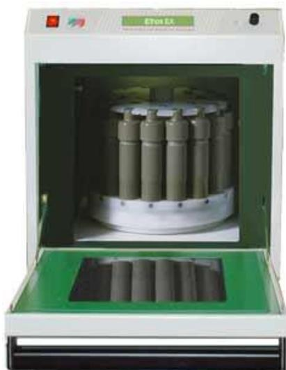
TIPO DI STRUMENTO: Forno **Mineralizzatore /estrattore**
