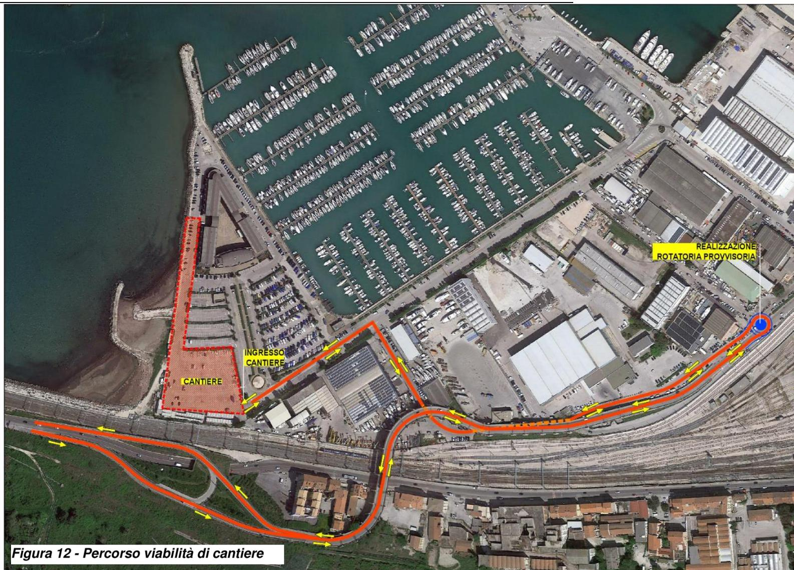
**Figura 12 - Percorso viabilità di cantiere**
