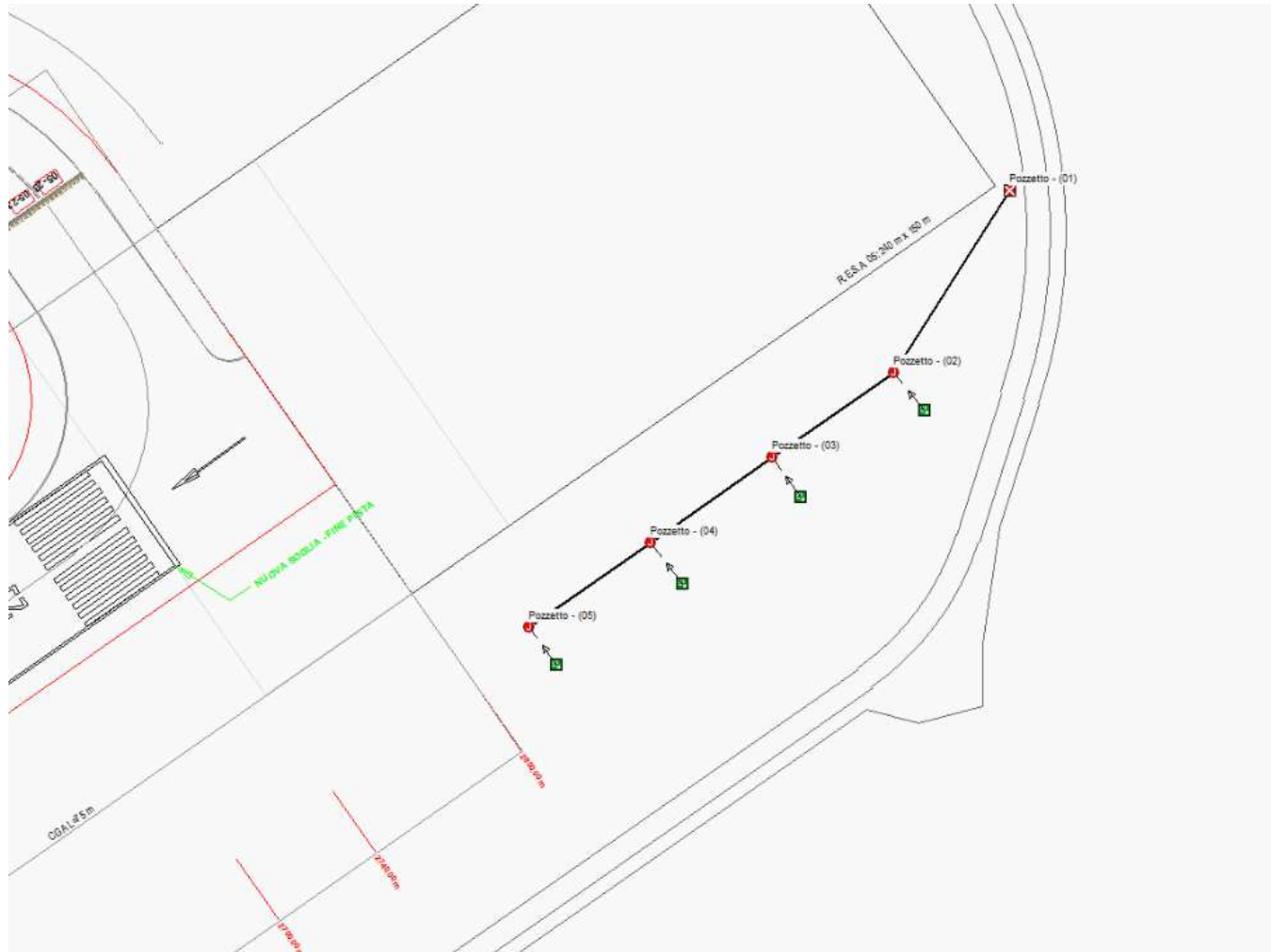
Fig. 7 Schema planimetrico esemplificativo della Rete 2 – Modello idraulico Storm and Sanitary Analysis 2017
