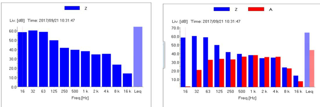
Rispetto alle campagne di misura dei precedenti anni, è stato introdotto un aggiornamento del software dello strumento di misura (fonometro Delta Ohm) che oggi consente di registrare entrambe le configurazioni sia sulle Ottave che sulle Terze di ottava.
