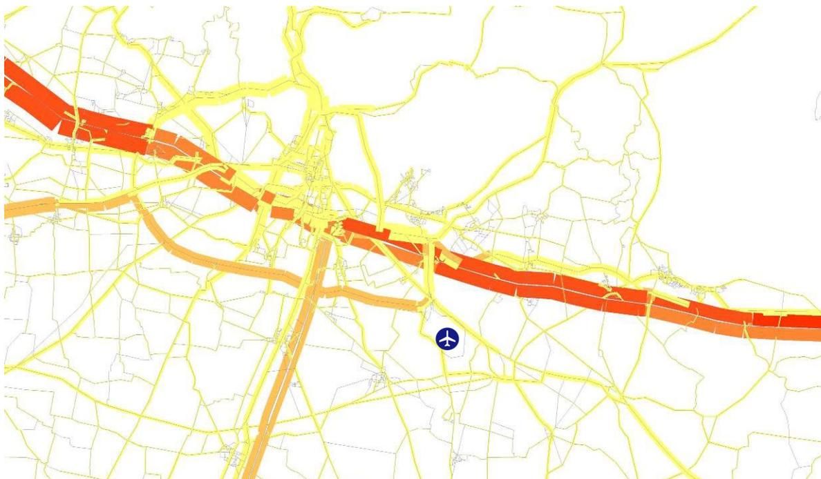
**Fig. 96 - Flussi di traffico operativo(mezzi pesanti) Brescia, scenario 2030**
