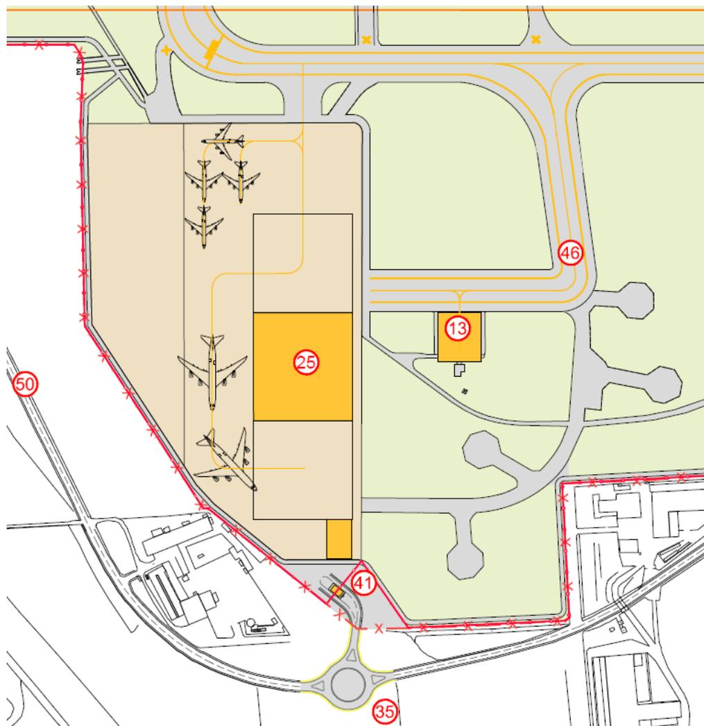
**Fig. 103 – Hangar per la manutenzione e la demolizione aeromobili (n.25), collegamento alla TWY A (n.46), hangar aviazione generale (n.13), nuovo varco e rotonda di ingresso (n.41 e 35)**
