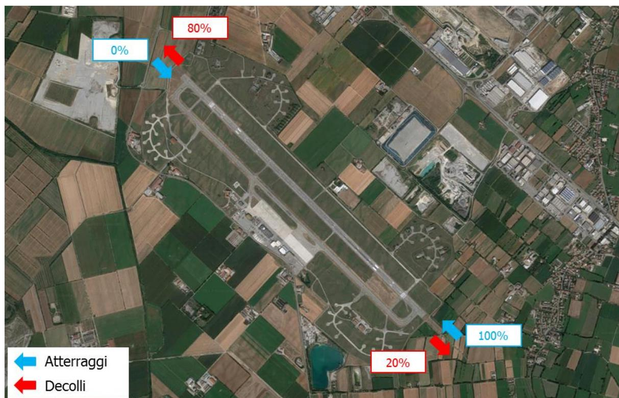
Figura 12-2 Modalità di uso dell'infrastruttura di volo assunta nel modello di simulazione per gli scenari operativi 2025 e 2030
