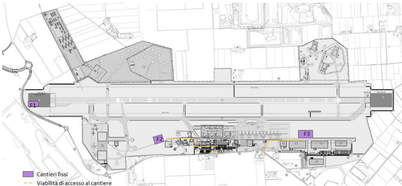
Figura 6-7 Localizzazione delle aree di cantiere
