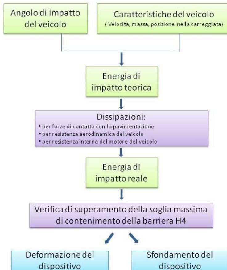
**Figura 2. Diagramma di flusso della procedura per il calcolo della deformazione/sfondamento del dispositivo di ritenuta**
