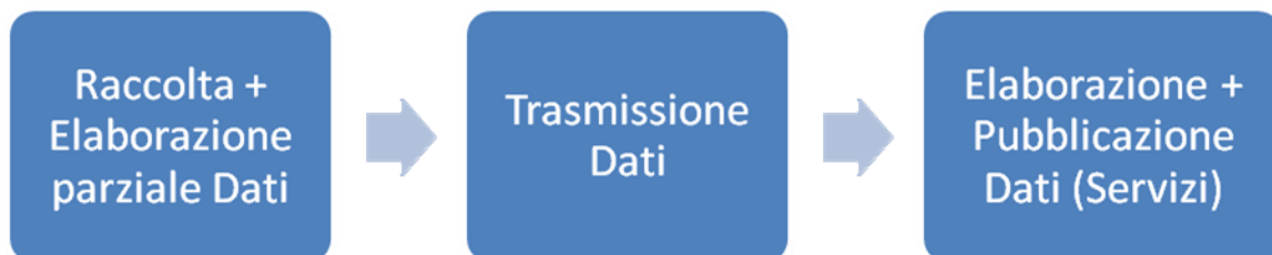
Figura 1: Processo Dati in un sistema di Infomobilità con gestione centralizzata dei dati
