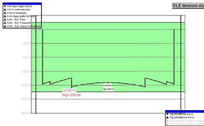
La neutralizzazione di alcuni trefoli in testata ha permesso di non superare la compressione limite del calcestruzzo nella zona delle testate della trave.
