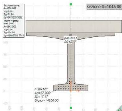
Avvalendosi del postprocessore TCAP si procede alla verifica della trave di bordo. Vengono disposti nella sezione 30 trefoli da 1/2" con baricentro a 17.17 cm dal lembo inferiore. Questo corrisponde ad una precompressione che porta al seguente stato tensionale al taglio dei trefoli:
