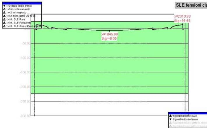
I grafici delle tensioni sul calcestruzzo ai lembi della sezione evidenziano una precompressione al limite, pur restando all'interno dei limiti consentiti dalla normativa. Non è possibile aumentare ulteriormente il grado di precompressione.
