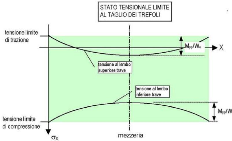
Per limitare le tensioni alle testate della trave si ricorre usualmente all'inguinamento di alcuni trefoli vicino alle estremità, e quindi all'annullamento del loro effetto in quelle sezioni. Tenendo conto della situazione appena illustrata, le zone tensionali di utilizzo delle fibre della sezione di mezzeria vengono scelte come illustrato nella figura seguente
