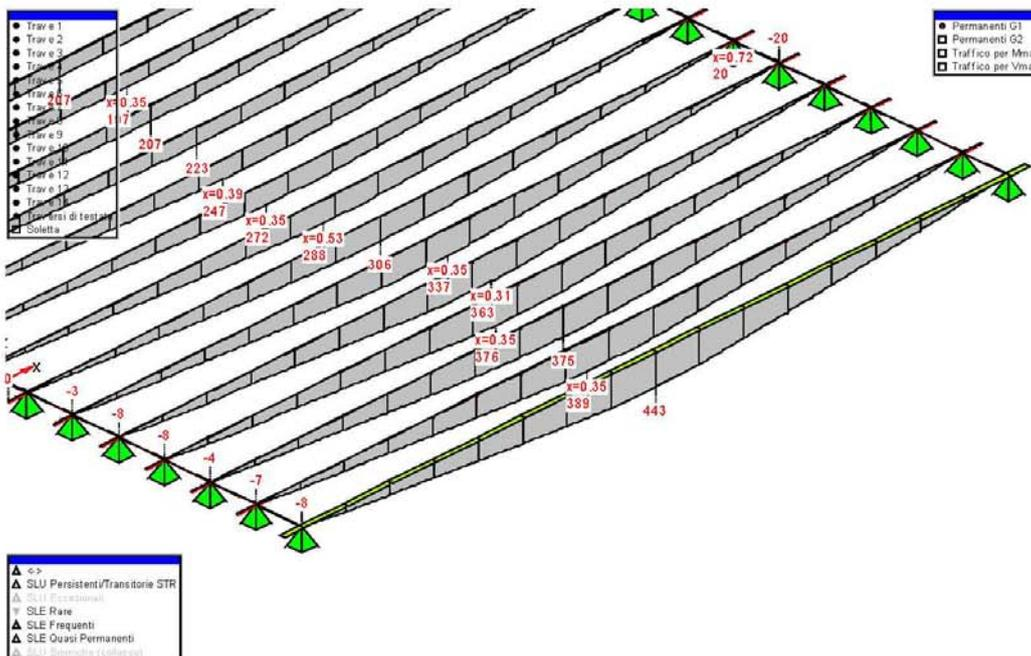
Conducendo l'analisi fino alla verifica delle sezioni si converge ad una disposizione di armatura da precompressione che è uguale per quantità di trefoli a quella con luce di calcolo di 10 m ma con risultante più bassa, quindi con maggiore eccentricità sulla sezione della trave. L'andamento delle tensioni longitudinali al lembo inferiore della trave al taglio dei trefoli risulta "al limite":
