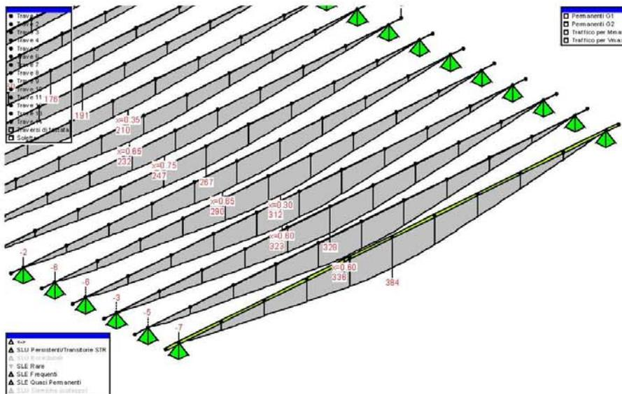
Dovendo eseguire un calcolo il cui fine è quello di valutare la complessiva ottimizzazione degli elementi ed operare la giusta scelta in fase di dimensionamento, si dovrà eseguire la verifica di resistenza della trave di bordo che è quella che impone la scelta più restrittiva.
