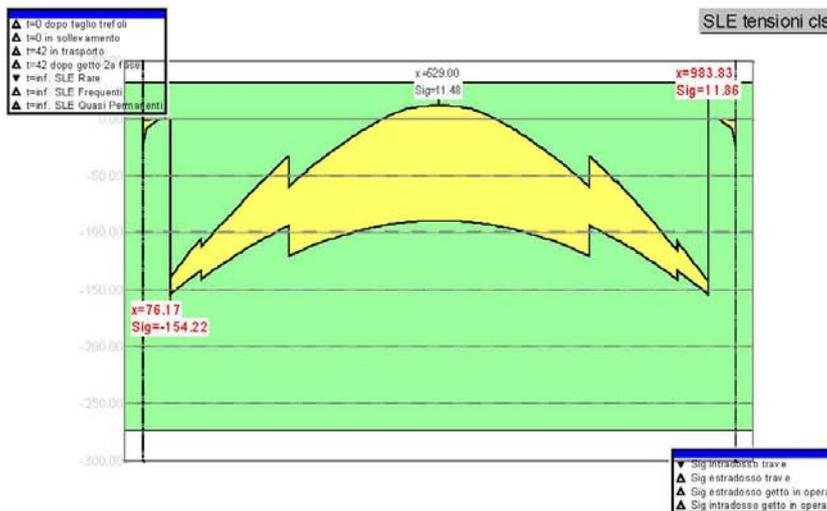
L'analisi alternativa qui esposta ha espresso un dimensionamento delle armature di precompressione che ha portato ad uno stato tensionale ottimale sia in fase di rilascio della precompressione che in fase di esercizio. Una serie di analisi condotte aumentando la luce ha portato a considerare 10.80 [m] la luce limite per questo tipo di struttura.
