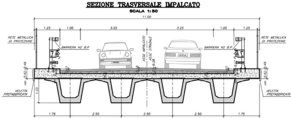
Figura 4: Sezione trasversale
