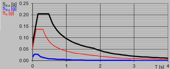
**Parametri e punti dello spettro di risposta orizzontale per lo stato limSLV**
